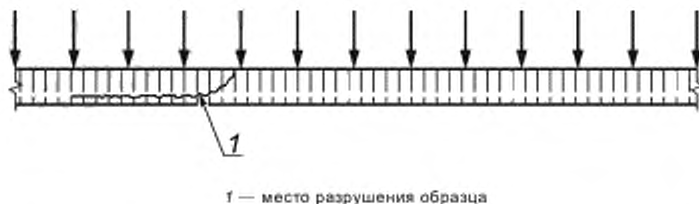
Рисунок В.6 — Типичная схема разрушения сердечника от сдвига
