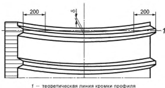
Рисунок 20 — Схема измерения серповидности
